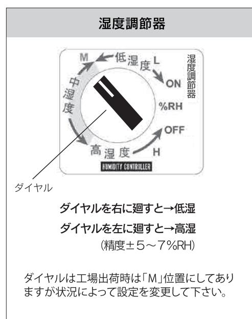
ダイヤルは工場出荷時は「M」位置にしてありますが状況によって設定を変更して下さい。
