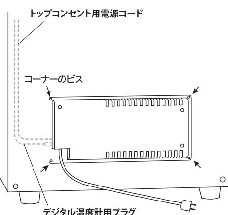
※H-180D-M II、H-155WD-M II、H-205WD-M IIのドライユニットは少し大きく形状が違いますが、外し方は同じです。
