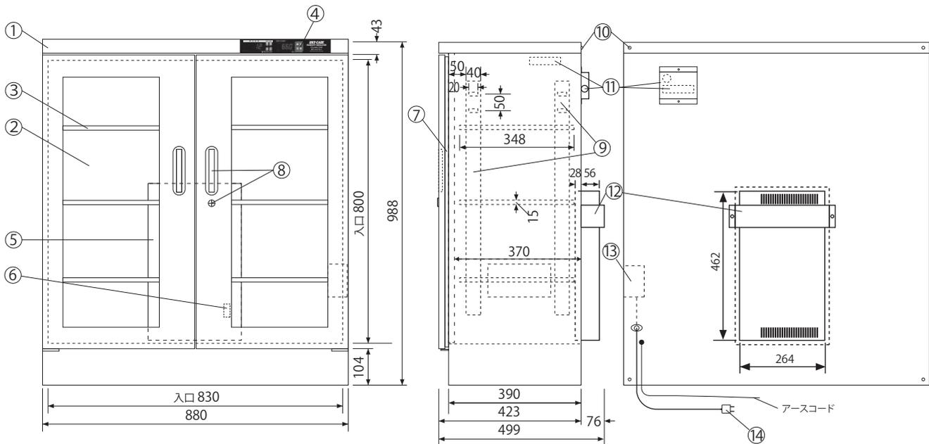
◆ 棚板上下移動可 (50mm間隔)、取り外しもできます。
