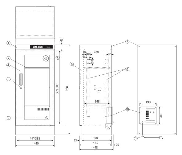
◆ 棚板上下移動可(50mm間隔)、取り外しもできます。 (棚板寸法 W407×D348×H15mm)
