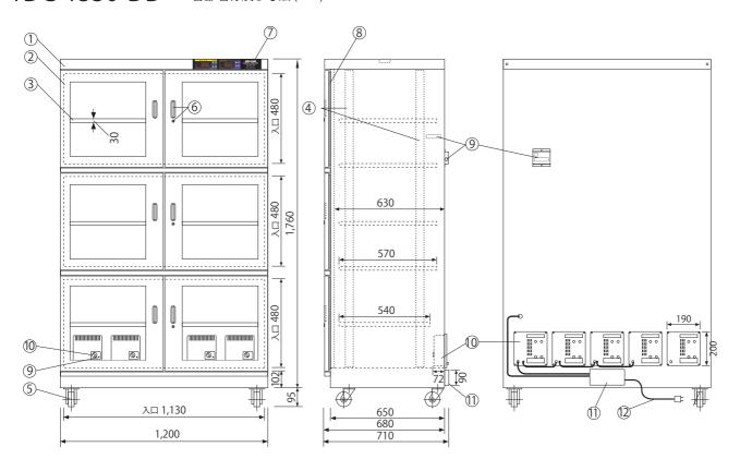
◆棚板上下動可、取り外しもできます。 (棚板寸法 W1,165×D570(下段のみD540)×H30)
