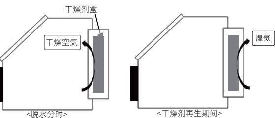
GB内部采用高性能脱水装置进行脱水，该脱水装置采用在防潮仓库“DRY-CABI”中栽培的技术开发，该仓库已有36年的历史记录。通过半自动控制干燥干燥剂，可长时间反复使用，免维护。由于不使用循环泵，结构紧凑，振动小，运行噪音低，功耗低。它可广泛用于处理吸湿性材料和化学品以及讨厌高湿度的工作。
