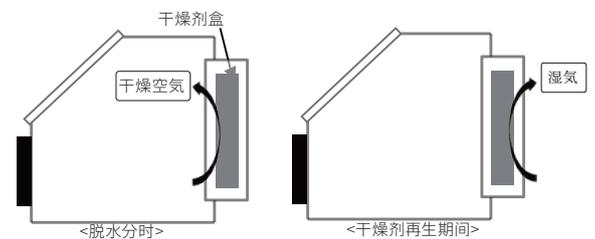
GB内部采用高性能脱水装置进行脱水，该脱水装置采用在防潮仓库“DRY-CABI”中栽培的技术开发，该仓库已有36年的历史记录。通过半自动控制干燥干燥剂，可长时间反复使用，免维护。由于不使用循环泵，结构紧凑，振动小，运行噪音低，功耗低。它可广泛用于处理吸湿性材料和化学品以及讨厌高湿度的工作。
