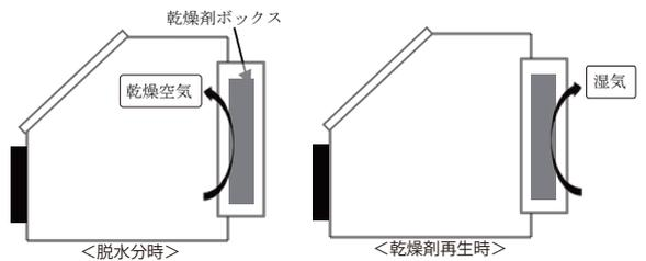
35年の実績がある防湿庫「DRY-CABI (ドライキャビ)」で培った技術を応用することで開発した高性能な脱水分装置でGB内を脱水分します。半自動制御による乾燥剤再生によって繰り返し長期間メンテナンスフリーでご使用いただけます。
