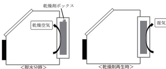
38年の実績がある防湿庫「DRY-CABI（ドライキャビ）」で培った技術を応用することで開発した高性能な**脱水分装置**でGB内を脱水分します。半自動制御による乾燥剤再生によって繰り返し長期間メンテナンスフリーでご使用いただけます。循環ポンプを使用しないので、コンパクト・低振動・低作動音・低消費電力。吸湿性材料・薬剤の取り扱いから高湿度を嫌う作業などに幅広くご利用いただけます。
