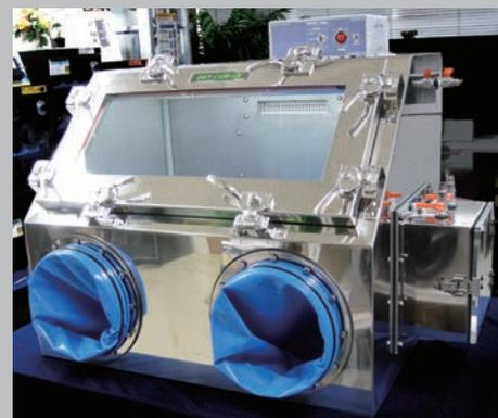
**全品特注仕様**: 脱水分装置標準装備、窒素仕様、HEPAフィルター仕様、高温仕様など
