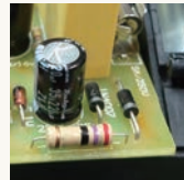
制御基板の電源部
